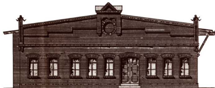
Oben: Schuppen 9 von der Wasserseite und in der Ansicht von Norden. Ein weit ausgestelltes Vordach schützt den Güterumschlag auf dem Kai.
